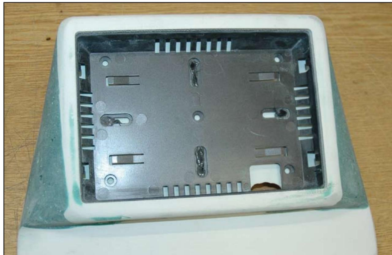
A l'aide de fibre et de mastic, Hifimobile réalise une forme harmonieuse au support. Ça paraît simple comme ça, mais cela demande un gros travail de ponçage et de masticage.
